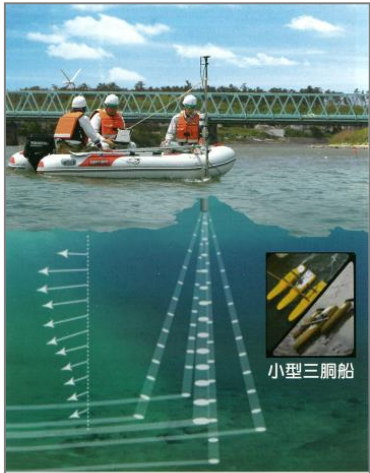
ADCP(M9)による流向・流速、水深観測イメージ 深浅測量(音響測深機)におけるADCP(M9)の活用
